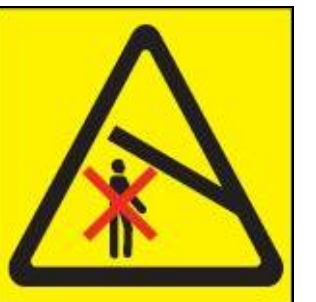
Nicht unter dem Förderer aufhalten! Sicherheitsabstand 5 m.
