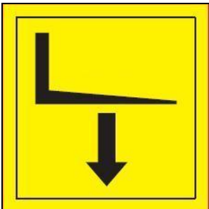
Ansetzstelle für Gabelstapler.
