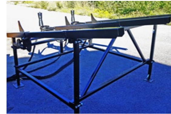
Zuführtisch mittel mit Stammportionierer
